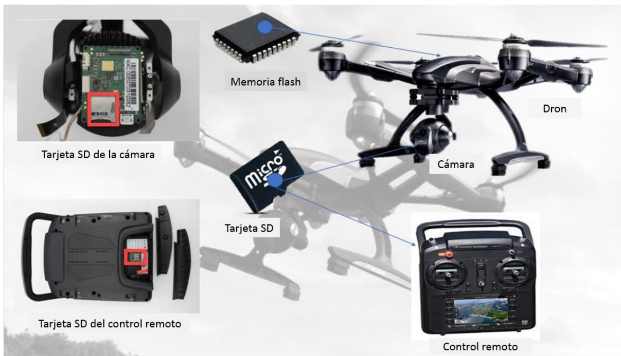
Figura 38 - Ubicaciones de datos en el Yuneec Typhoon Q500 4K
