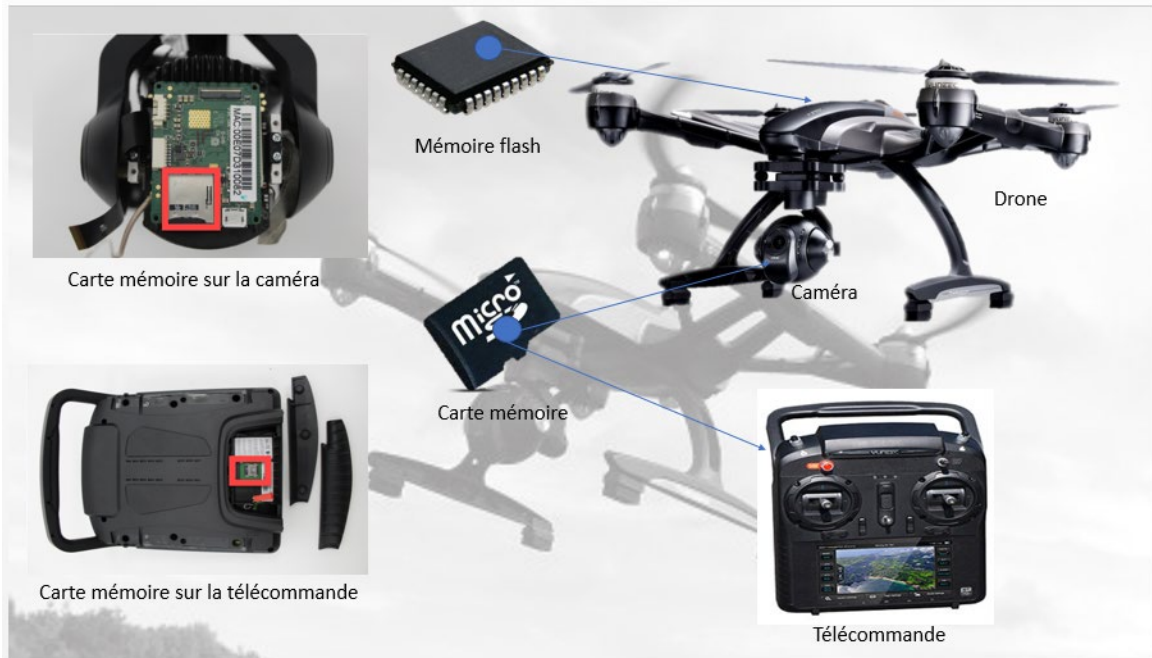
Figure 38 : Emplacements de stockage des données sur le Typhoon Q500 4K de Yuneec
